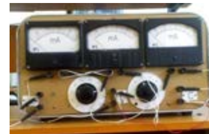
Рисунок 2 – Установка для исследования явления резонанса напряжений
